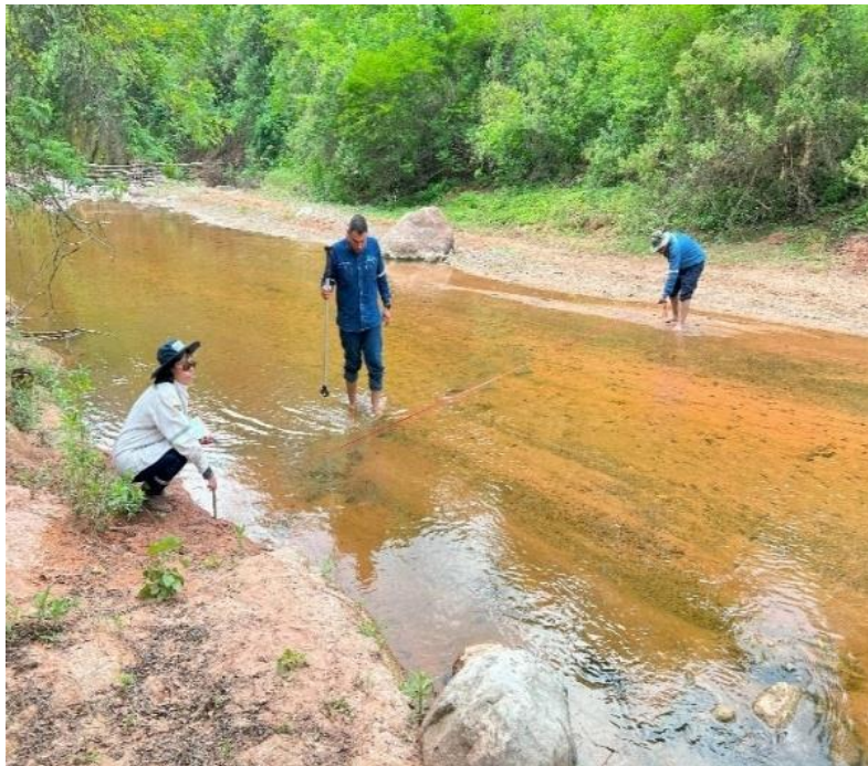
Figura 2-61: Medición de la velocidad del río Soledad con correntómetro
